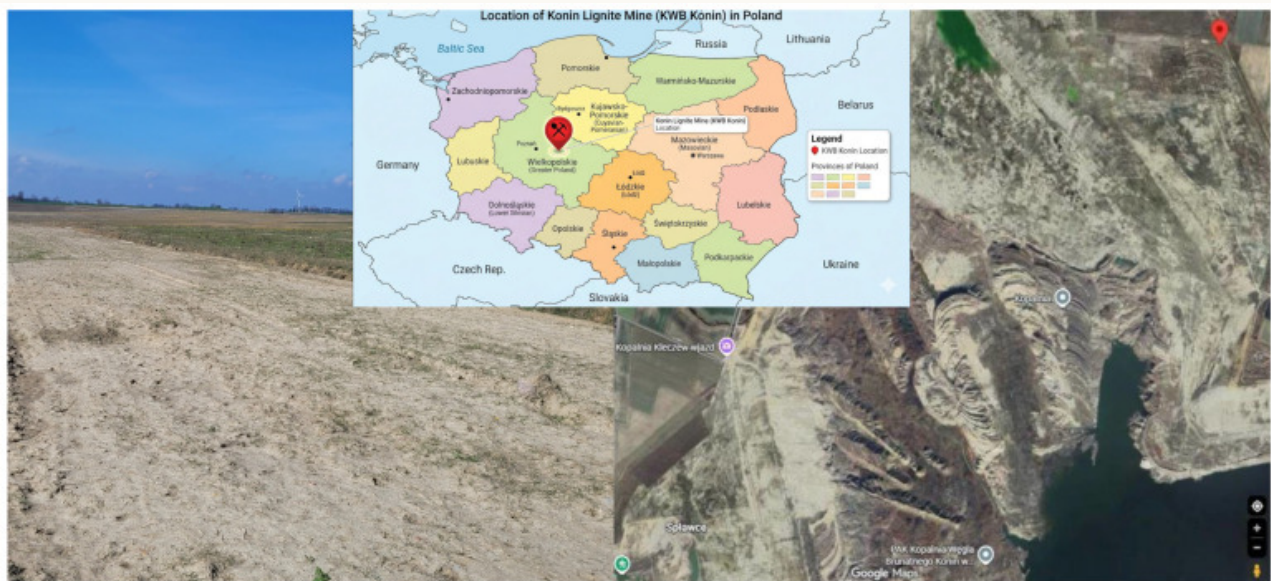
Feldstudie HYP-011 auf Bergbaufolgeland bei Konin/Kleczew. Abbildung 1 aus Choińska-Pulit et al. (2026), CC BY 4.0. Die Darstellung zeigt Kontrollfläche, Behandlungsfläche und Trennstreifen. Jede Variante umfasste eine große Fläche; viele gemessene Pflanzen ersetzen keine unabhängige Wiederholung von Versuchspartzellen.
